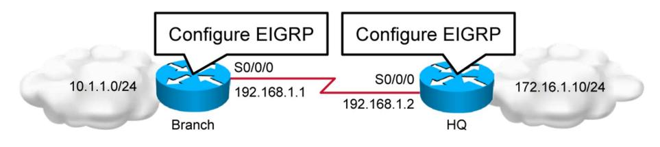
Branch(config)**#router eigrp 100** Branch(config-router)**#network 10.1.1.0** Branch(config-router)**#network 192.168.1.0**
